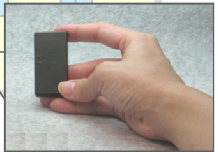
ZigBee®小型タグ (3軸加速度センサ内蔵)
